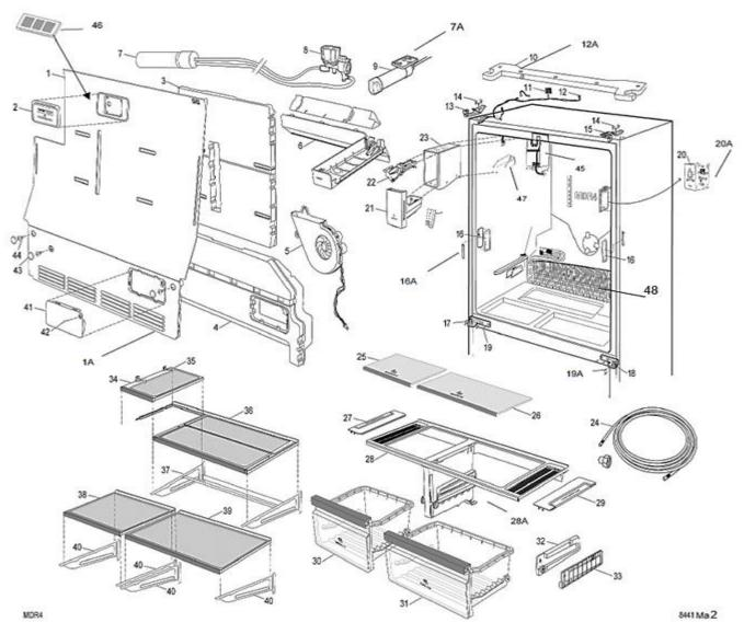
Note 19:SCREW TRILOB M5X16 42,44: SCREW TRUSS 4.2X13
